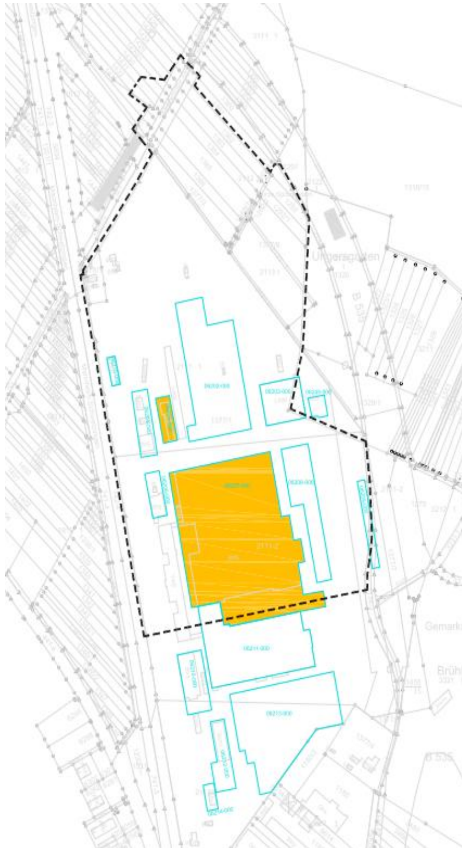
Abbildung 3: Lage der Altlastenverdachtsflächen und der als Flächen (dunkel dargestellt), deren Böden mit erheblichen umweltgefährdenden Stoffen belastet sind.
